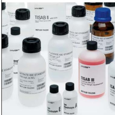
在所有使用离子选择性电极的分析方法中, 都必须在测量或校准前在样品和标准液中添加适量的离子强度调节剂。该溶液可以确保样品和标准液拥有相似且恒定的离子强度。所有离子选择性电极手册中均提供关于离子强度调节剂类型和数量的说明。
